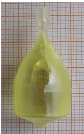
Fig. 1. As-grown \text{Tm}^{3+}:\text{Li}_2\text{Gd}_4(\text{MoO}_4)_7 crystal.
